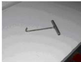
Foto 1: Manija portátil utilizada en el acarreo y retiro de tubos del mostrador.
