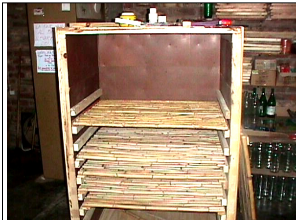
Vista del horno deshidratador en construcción
